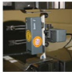
Bestimmung der Querkontraktionszahl im Zugversuch
