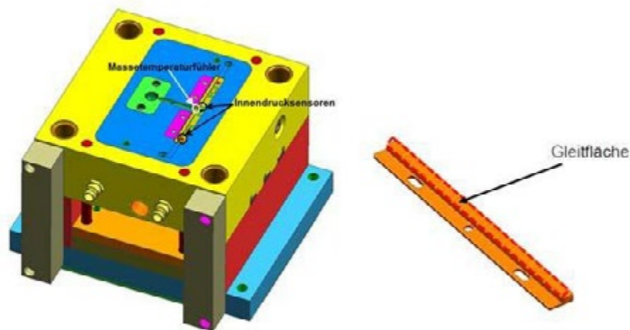
Abb. 3: links: Auswerferseite mit Sensorik rechts: Versuchskörper (Gleitfläche: 100mm x 5mm)
