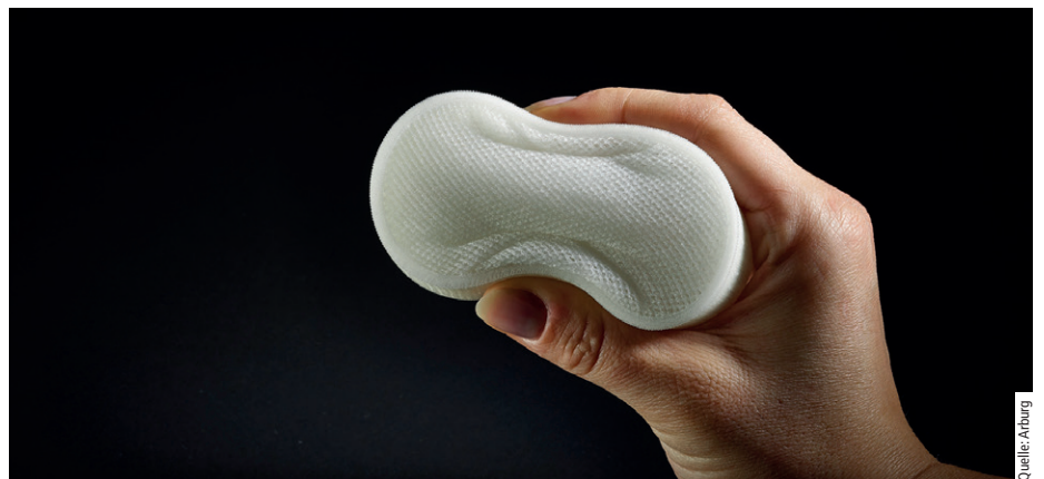
Abb. 5: Flexibel und dennoch fest: Ein thermoplastisches Polyester-Elastomer wurde mit Hilfe von Stützmaterial zu einer flexiblen, aus zwei Teilen zusammensetzbaren Schuhsohle verarbeitet.
