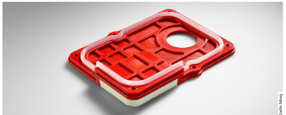
Abb. 4: Mit dem AKF-Verfahren kann man die Bauteildichte gezielt beeinflussen: flexible Wabenstrukturen aus TPE.
